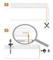
Für Anfang und Ende der Terrasse stehen Ihnen passende Start-/Endclips (Art.Nr. 1014) zur Verfügung. Die UK muss bündig zur unteren Nutwange eingekürzt werden, damit der Clip passgenau und kraftschlüssig funktioniert.
