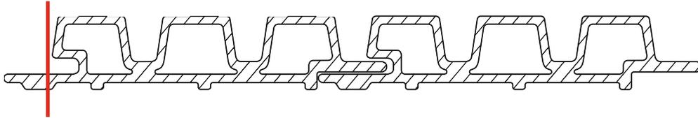
Dieses bearbeitete Profil muss als erstes auf der Holz- oder Alu-Unterkonstruktion befestigt werden. Das Profil sollte ca. 10 mm über die Unterkonstruktion überstehen damit eine optimale Tropfkante entsteht.
