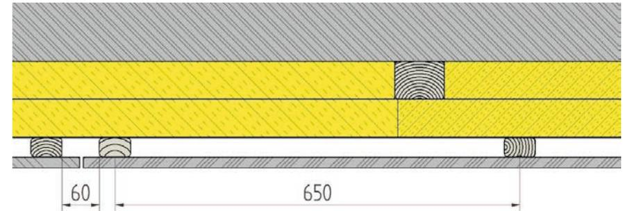
Bei der Planung der Lattung sollten die verfügbaren Längen der Fassadenprofile berücksichtigt werden, da an allen Längenstößen bei einer horizontalen Montage immer 2 Traglatten eingebaut werden müssen. Optimal ist ein Abstand zwischen den 2 Traglatten von ca. 60 bis max. 100 mm. Auch sollten bei der Planung die Abstände zu den Fenster und Türen beachtet werden.
