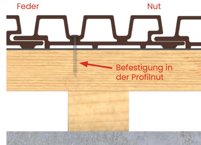
Achtung: Der Schraubenkopf muss auf dem Profil aufliegen, darf aber keine Kraft darauf ausüben, die zu Rissen führen kann. Stellen Sie bei der Verschraubung den entsprechenden Drehmoment ein.
