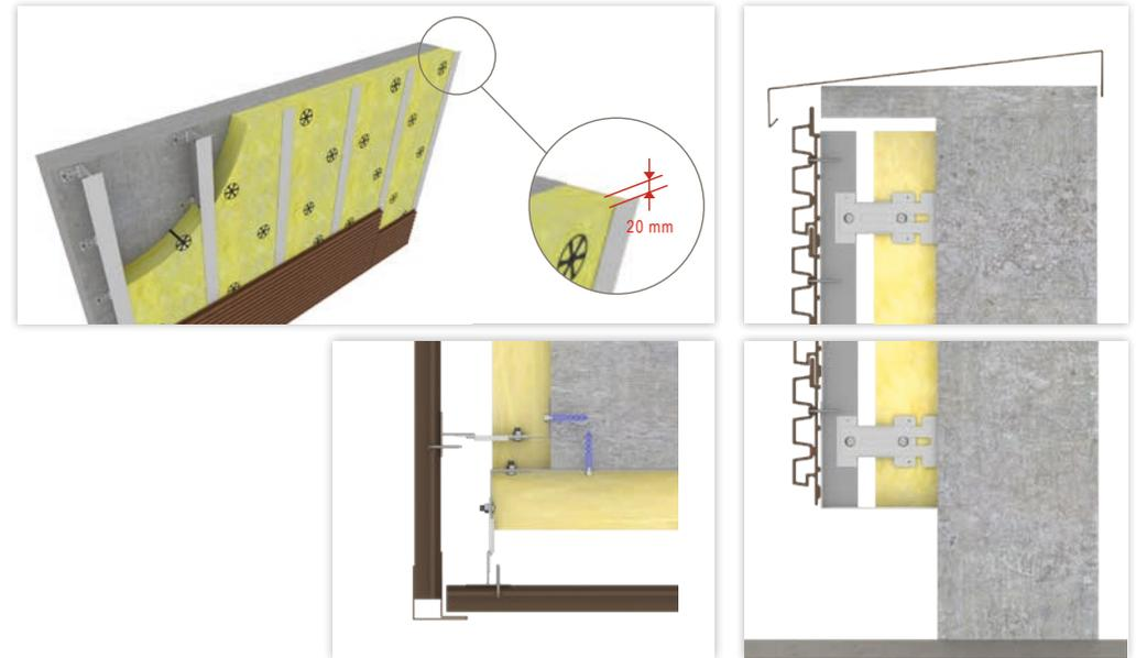
Bei der **vertikalen Montage** der WEO®-Fassadenverkleidung muss eine zusätzliche Alu-Unterkonstruktion als Traglattung montiert werden. Die erforderlichen Längsstöße sollten, wenn möglich als Geschoßstoß ausgebildet werden. Dazu sollten entsprechende Z-Profile verwendet werden die gleichzeitig das Eindringen von Wasser von Oben in die Profile verhindert. Wenn zusätzlich eine Brandsperre beim Geschoßstoß erforderlich ist, können zusätzliche Maßnahmen erforderlich sein.
