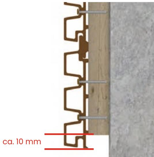
Bevor das erste WEO®-Fassadenprofil befestigt wird, müssen die erforderlichen Schutzgitter (Kleintierschutz) montiert werden. Für die Befestigung der Fassadenprofile müssen unsere Bohrschrauben 4,2 x 38 aus Edelstahl 304 verwendet werden. Die Schrauben sind im Farbton der WEO®-Fassadenprofile erhältlich. Die Schrauben können für Holz- und Alu-Unterkonstruktionen verwendet werden und haben eine selbstbohrende Spitze. Zusätzlich ist unter dem Schraubenkopf eine Anti-Strip-Einkerbung vorhanden.
