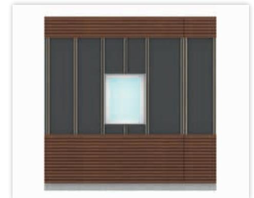
Dazu sollten entsprechende Z-Profile verwendet werden die gleichzeitig das Eindringen von Wasser von Oben in die Profile verhindert. Wenn zusätzlich eine Brandsperre beim Geschoßstoß erforderlich ist, können zusätzliche Maßnahmen erforderlich sein.
